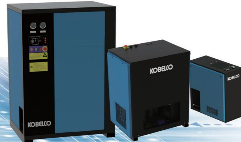
热而潮湿的压缩空气经过与冷却到压力露点的冷空气热交换后进入蒸发器，与制冷剂进行热交换，温度降至压力露点温度，水份在此温度下析出，通过冷凝器将析出的水分、油和杂质分离，通过排水器将其排出机外。而干燥的低温空气进入交换器温度升高后输出。
