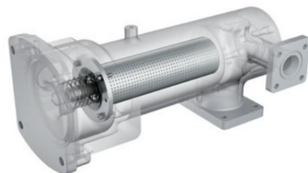
采用扩张型和多孔板式消音器的组合，在更广范围的频率带，更好地发挥防噪效果。同时也对变频机转数控制产生的噪音变动进行有效的对应。
