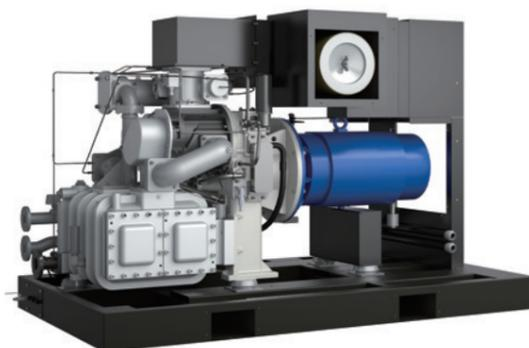
通过降低压损和辅机动力，以及装载IPM电机、或IE3电机、离心风扇等高效部件来有效地降低能耗。此外，通过优化冷却器设计，降低排气温度，使后续部件小型化，进一步达到节能的目的。
