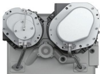
轴端泵内置于齿轮箱。通过高效的主电机驱动，降低电耗。由于内置于齿轮箱内，配管连接点少，因此也降低了漏油风险。
