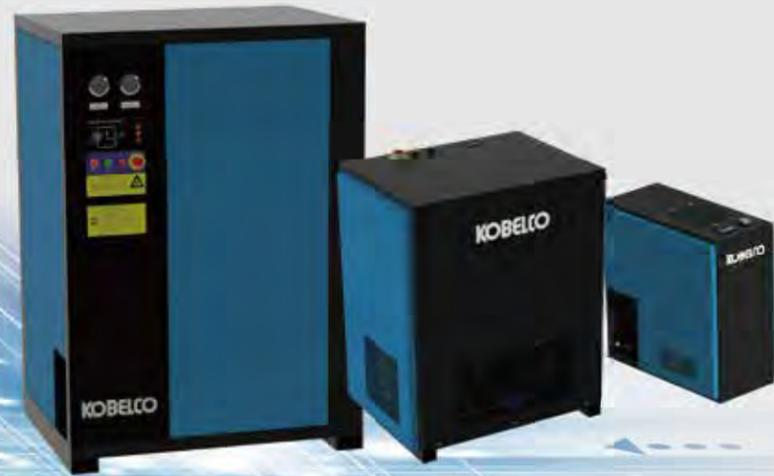
热而潮湿的压缩空气经过与冷却到压力露点的冷空气热交换后进入蒸发器，与制冷剂进行热交换，温度降至压力露点温度，水份在此温度下析出，通过冷凝器将析出的水分、油和杂质分离，通过排水器将其排出机外。而干燥的低温空气进入交换器温度升高后输出。
